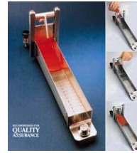
เครื่องวัดค่าความหนืด ค่าการยืดเกาะ สำหรับผลิตภัณฑ์อาหาร สี กาว เป็นต้น (Consistometer)
