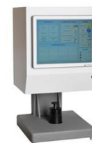
เครื่องวัดค่าแรงความขาวสว่าง (Brightness) ค่าสี (Color) ค่าความขาว (Whiteness) ค่าความทึบแสง (Opacity) ค่าหมักตกต่าง (ERIC) ของกระดาษแบบอัตโนมัติ -Spectrophotometer For the determination of whiteness, color, opacity, etc. Product code: 11.305
