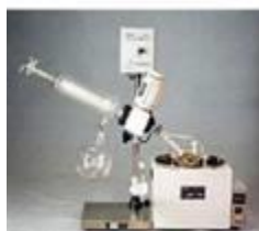
เครื่องระเหยสารแบบหมุน R201BL rotary evaporator
