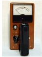
เครื่องวัดความชื้นสำหรับตัวอย่างที่เป็นผงหรือเม็ด - Model G9 for Powdered and Granular Materials
