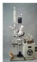
เครื่องระเหยสารแบบหมุน R1002B rotary evaporator
