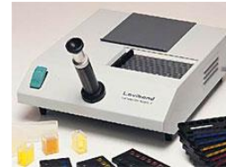
เครื่องวัดสีน้ำมันพืชแบบ Manual เหมาะสำหรับน้ำมันมะพร้าว น้ำมันปาล์ม น้ำมันถั่วเหลือง น้ำมันเมล็ดดอกทานตะวัน น้ำมันรำข้าว เป็นต้น
