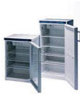
ตู้ควบคุมอุณหภูมิที่ต่ำ (Incubator) เหมาะสำหรับการทดสอบหาค่า BOD การเลี้ยงเชื้อ เซลล์ตัวอย่างหรือสารเคมี
