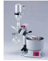
เครื่องกลั่นระเหยแบบสุญญากาศ (Rotary Evaporator) เหมาะ สำหรับการกลั่นแยกน้ำออกจากเพื่อให้สารเข้มข้นขึ้น การกลั่นสารเพื่อ นำมาใช้ใหม่ เป็นต้น
