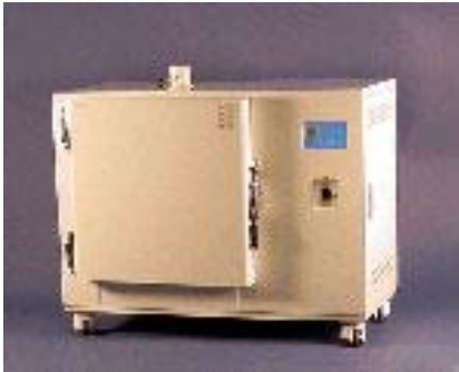
(ตู้อบลมร้อนอุณหภูมิสูง สูงสุด 450 องศาเซลเซียส)
