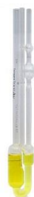
หลอดแก้ววัดค่าความหนืดแบบ Capillary Viscometer
