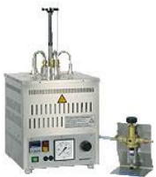
เครื่องทดสอบปริมาณยางเหนียว (Gum Content Tester)
