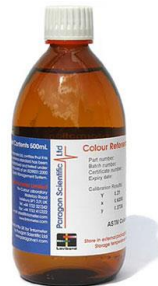
น้ำมันปิโตรเลียมมาตรฐาน สำหรับการสอบเทียบเครื่องมือ
