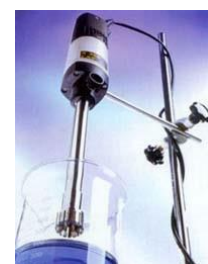
เครื่องผสมสารให้เป็นเนื้อเดียวกัน ความเร็วรอบสูง (Homogeniser)
