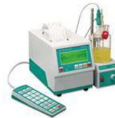
เครื่องวัดค่าปริมาณน้ำโดยวิธีการติเตรตแบบ Karl Fischer Titrator
