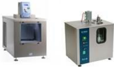
เครื่องมือทดสอบทางด้านความหนืด (Viscosity Bath) ของน้ำมันปิโตรเลียมตามมาตรฐาน ASTM D445
