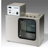
เครื่องวัดค่าความหนืดของน้ำมัน (Viscosity Bath acc. to ASTM D445)
