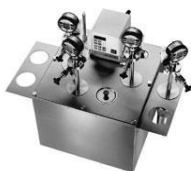
เครื่องทดสอบอายุการใช้งานของน้ำมัน (Oxidation Stability - Induction Period Method ตามมาตรฐาน D525, D2112, D2272)
