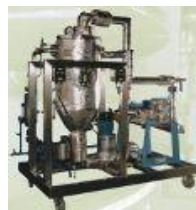
เครื่องวิจัยการเกิดแว็กซ์หรือไขของ น้ำมันแบบต่อเนื่อง รุ่น FT87 Loop Hydrogenation Pilot Plant
