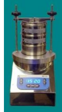
เครื่องคัดแยกขนาดด้วยการสั่นผ่านแผ่นตะแกรง (Sieve Shaker Machine)
