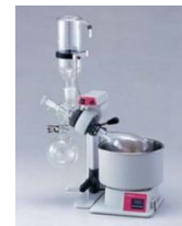
เครื่องกลั่นระเหยแบบสุญญากาศ (Rotary Evaporator) เหมาะสำหรับการกลั่นแยกน้ำออกเพื่อให้สารเข้มข้นขึ้น การกลั่นสารเพื่อนำมาใช้ใหม่ เป็นต้น
