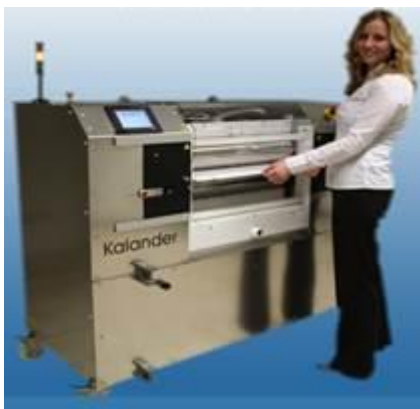
เครื่องทดสอบการขัดผิวกระดาษแบบต่อเนื่อง (Online Unit / Pilot Scale Calander Unit Type Sumet) พร้อมระบบวัดค่าความหนาต่อเนื่องด้วยเลเซอร์แบบอัตโนมัติ
