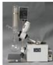
เครื่องระเหยสารแบบหมุน R204B3 Rotary evaporator
