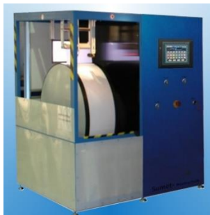
เครื่องเคลือบกระดาษแบบ Curtain Coating (Pilot Curtain Coater Model CC-5)
