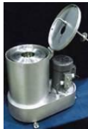
เครื่องปั่นเหวี่ยงแยกองค์ประกอบนม รุ่น FT27 CentriPeel Centrifuge
