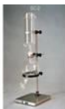
ชุดควบแน่นไอ Second condenser SC-2
